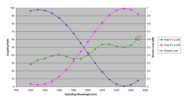
PM WDM FOR 2 µM OPERATION
